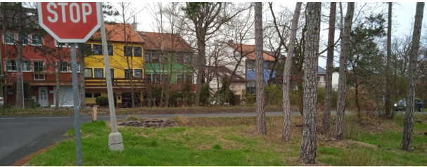
Pohled vpravo zpět je přehledný bez přerušení do vzdálenosti min. 35m. Úsek je v mírném klesání.
