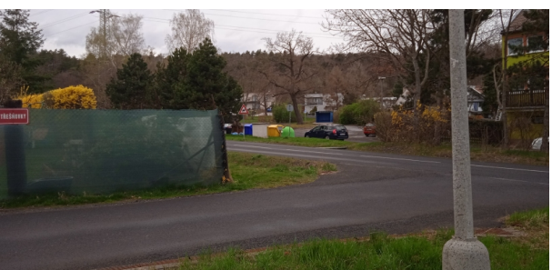
Pohled vpravo vpřed je přehledný bez přerušení do vzdálenosti min. 20m. S ohledem na nutnost odbočení přijíždějícího vozidla pod úhlem přesahující 90° je předpokládána rychlost pro brzdění předpokládána menší než 30 km/h. Úsek je v mírném stoupání.
